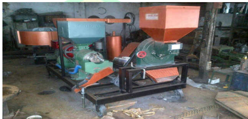
Gambar 3.2 konfigurasi penggilingan padi RMU
