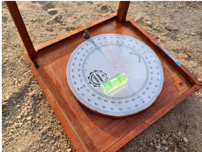
Gambar 3.7 Zawiyah Sanatir dan Waterpass (Bubble Level)
