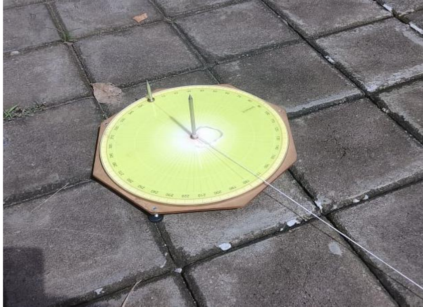
Gambar 4.25 Hasil Pengukuran menggunakan alat Istiwa'aini
