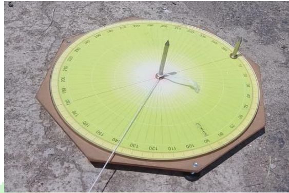
Gambar 4.5 Hasil pengukuran arah kiblat Masjid Baiturrohman dengan Istiwa'aini
