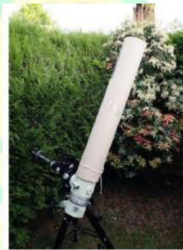
Gambar 3.6 Teleskop yang sudah terpasang Sun Shield.
