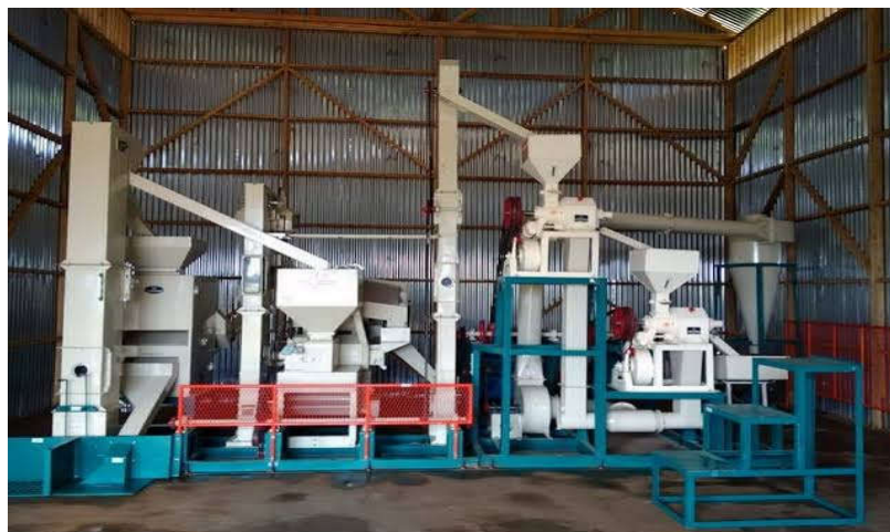
Gambar 3.4 konfigurasi penggilingan padi besar (PPB)
