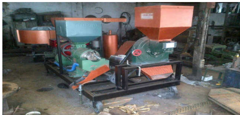
Gambar 3.2 konfigurasi penggilingan padi RMU
