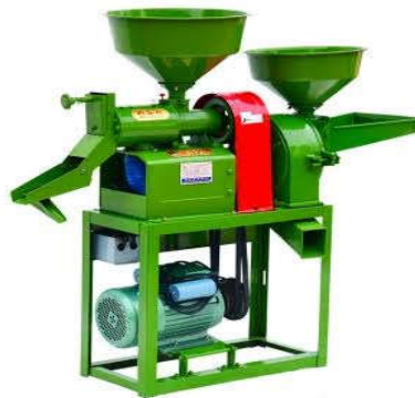
Gambar 3.1 konfigurasi penggilingan padi kecil
